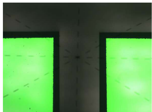
図 2: ダイシング後のウェハー上面図
